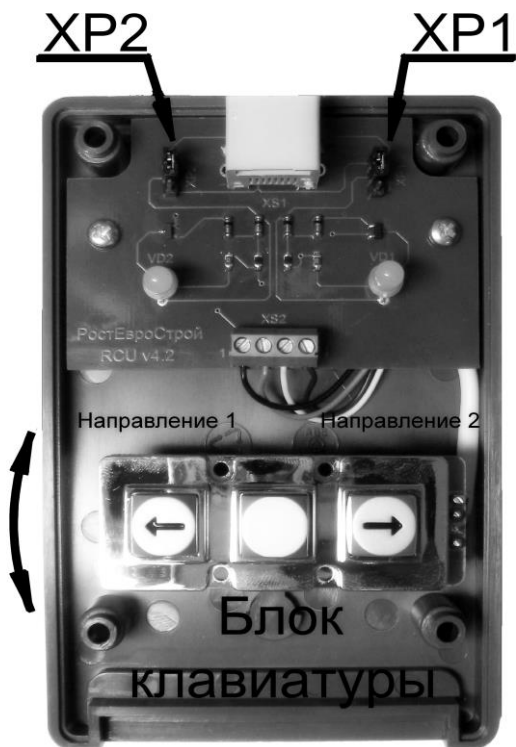
Вид пульта со снятой крышкой
